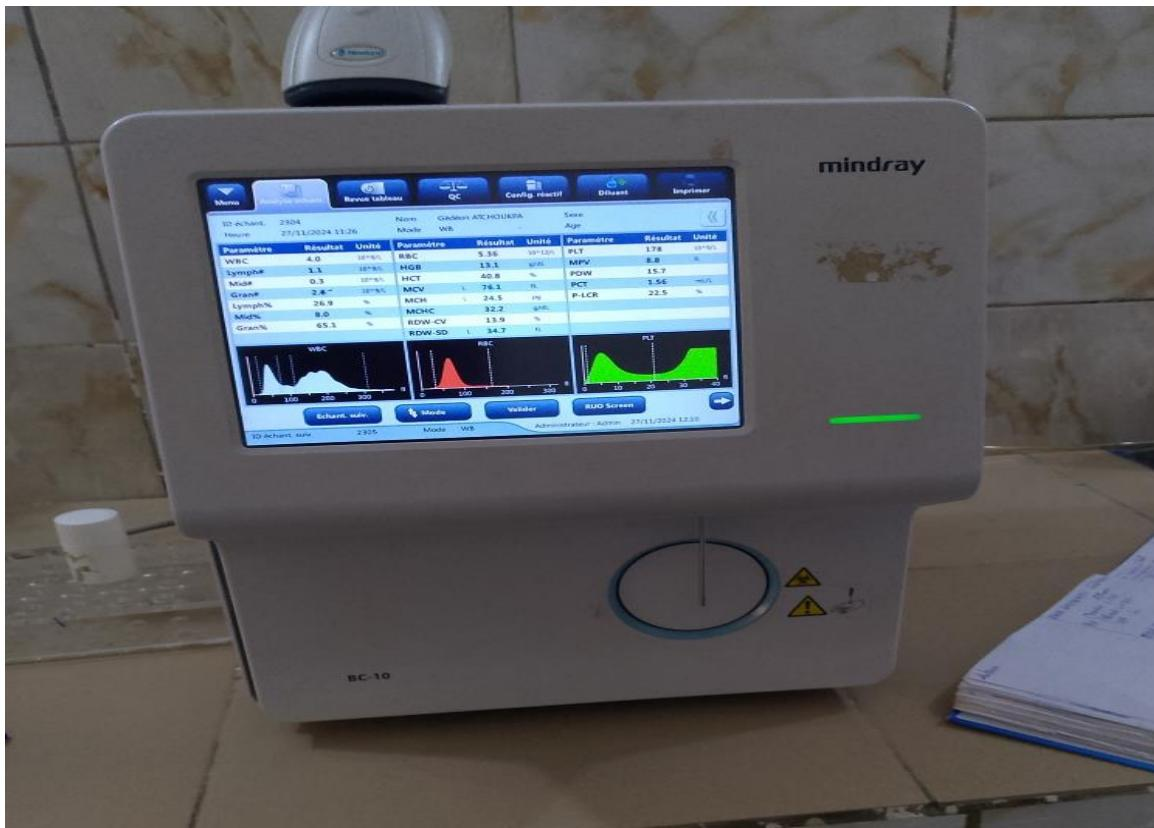
**NB:** Des maintenances périodique de un (01), deux (02); trois (03) mois sont programmées. Elles sont demandées de façon automatique par l'appareil. Exécuter la procédure en suivant les indications de l'appareil. Elle varient en fonction du type de maintenance.
